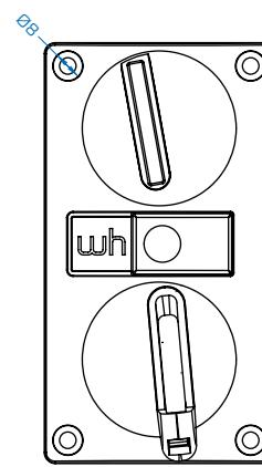
**EMP 850.xx mit Stahl-Frontplatte F 801 117 x 60 mm**
